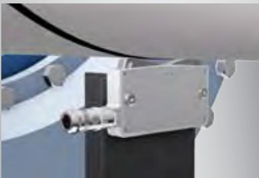
Der Abtastkopf ermöglicht eine sehr hohe Auflösung trotz grossem Axialschub und stark schwankendem Luftspalt.
