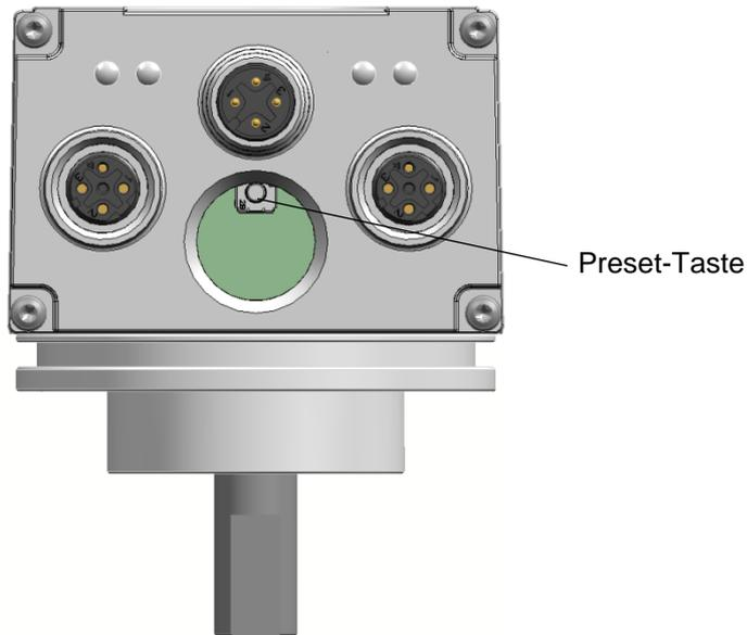
Ist der „EAX580 EtherCAT“-Drehgeber im EtherCAT-Zustand „Operational“ und mit einem EtherCAT Master verbunden, kann mit Hilfe der Taste ein Preset-Vorgang ausgelöst werden. Weiterführende Informationen hierzu finden Sie im Kapitel [Preset-Vorgang mit Taste](#).
