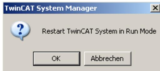
TwinCAT wird im „Run Mode“ gestartet. Um zu verifizieren, dass der EtherCAT Master mit der korrekten Zykluszeit arbeitet, überprüfen Sie Register „Online“ von "Device 4 (EtherCAT)". Bei einer konfigurierten Zykluszeit von 500  $\mu$ s sollte der Wert in „Frames / sec“ bei ca. 2000 liegen.
