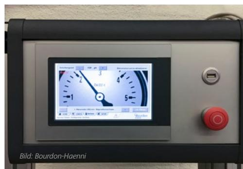
Die grafische Benutzerschnittstelle ermöglicht die Auswahl des entsprechenden Prüfzyklus und zeigt Messungen außerhalb des Toleranzbereichs sofort an.
