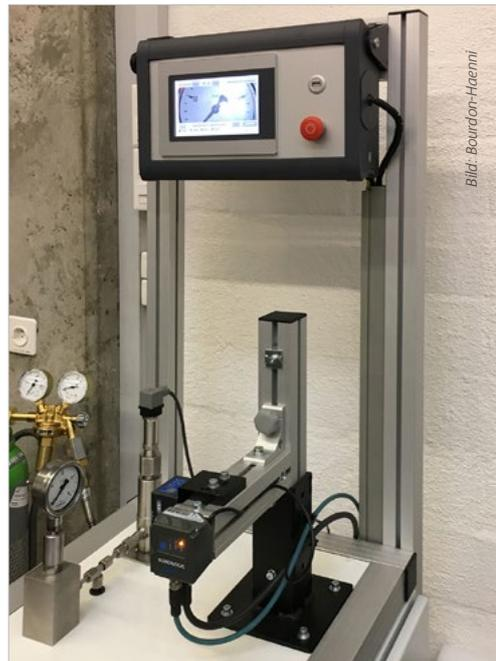
Nach der Erfassung der Serien- oder Bestellnummer wird das Manometer an das Prüfsystem angeschlossen und der entsprechende Prüfzyklus über die grafische Benutzerschnittstelle gewählt. Herzstück des Systems ist ein XF800 VeriSens® Vision Sensor von Baumer, der eine präzise Winkelberechnung vornimmt. Ein Steuersystem von B&R steuert den gesamten Prüfablauf.
