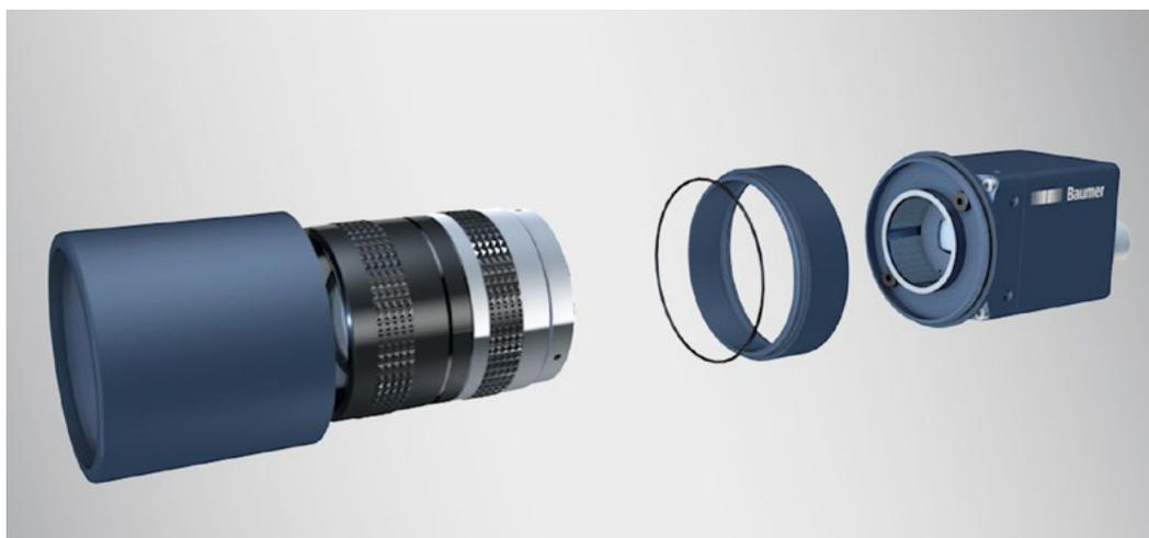
Dank patentiertem modularem Objektivschutzsystem in M47 oder M62 lassen sich Kamera und Objektive verschiedener Länge und Durchmesser mit einer variablen Anzahl an Zwischenringen schnell und flexibel schützen und erreichen die Schutzarten IP 54, IP 65 und IP 67.
