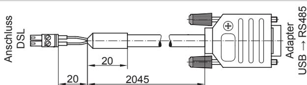
Anschlusskabel für DSL-RS485-Schnittstelle
