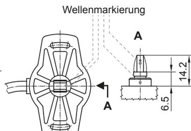
Der Drehgeber ist in Null-Grad-Position, wenn sich die Markierung auf der Welle in entgegengesetzter Richtung zum Kabelabgang befindet.
