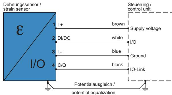
Ausgangssignal: IO-Link, parametrierbar
