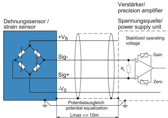
Ausgangssignal typisch: Sig+ / Sig- = ±1,3 mV/V (der gemessene Wert ist auf dem Sensor angegeben)
