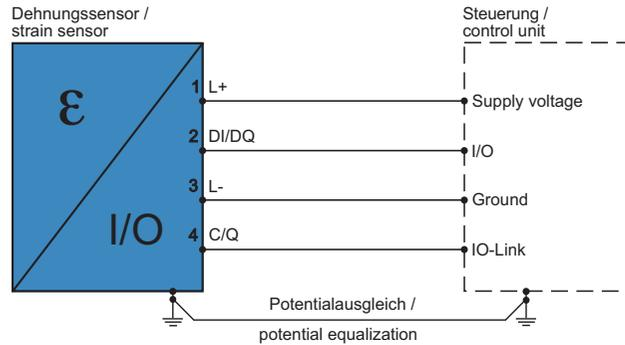
Ausgangssignal: IO-Link, parametrierbar
