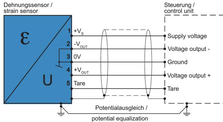
Ausgangssignal: V<sub>OUT</sub> = ±10 V
