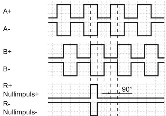
Abb. 12: Ausgangssignale bei positiver Drehrichtung (Nullimpuls R+ und R- sind nur an Zusatzausgang II verfügbar)
