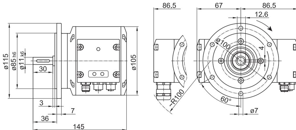
Abb. 18: Abmessungen des Vollwellengebers mit EURO-Flansch B10 (Abmessungen in mm, wenn nicht anders angegeben)
