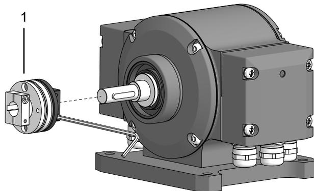
Abb. 5: Kupplung an Antriebswelle des Drehgebers montieren
