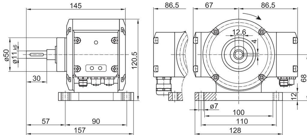
Abb. 19: Abmessungen des Vollwellengebers mit Gehäusefuss B3 (Abmessungen in mm, wenn nicht anders angegeben)
