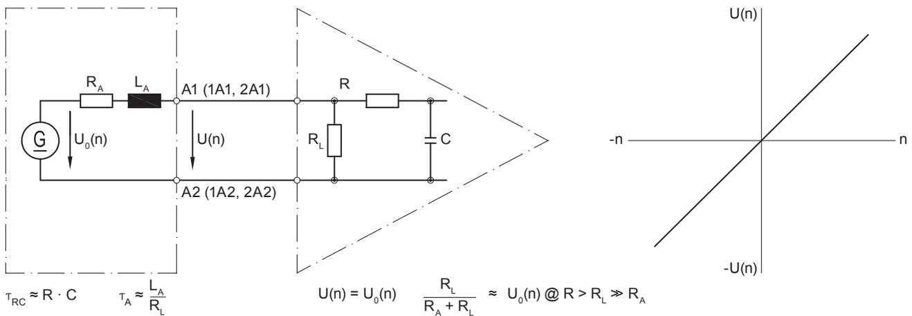
Polarität bei positiver Drehrichtung (siehe Abmessung) / A1 (1A1, 2A1): + (VDE) / A2 (1A2, 2A2): - (VDE)
