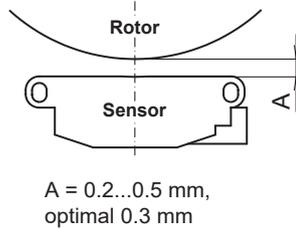
Distanzband als Montagehilfe für optimalen Sensor-Rotor-Abstand verwenden.
