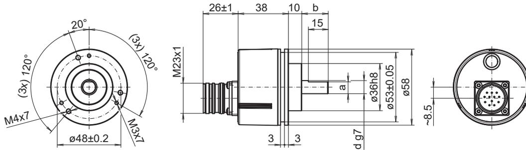
Klemmflansch, Flanschdose M23, axial
