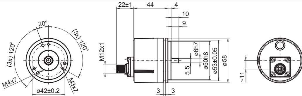
Servoflansch, Flanschdose M12, axial
