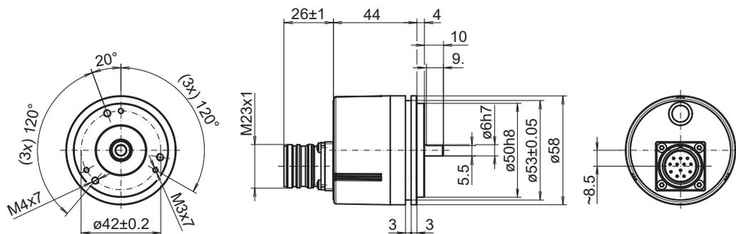
Servoflansch, Flanschdose M23, axial
