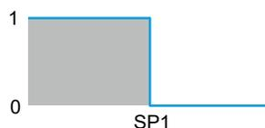
Abb. 4: Sensor im Messmodus *Single Point*
