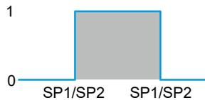
Abb. 6: Sensor im Messmodus *Window*
