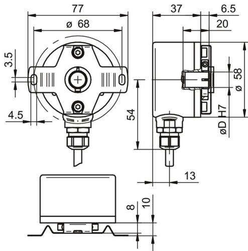
Mit Kabel und Statorkupplung
