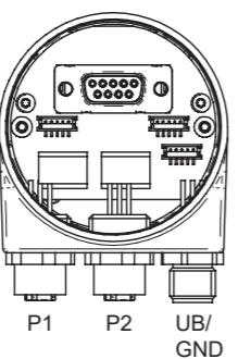
**Drehgeber-Gehäuse und Schirmgeflecht des Anschlusskabels sind nur dann optimal verbunden, wenn das Schirmgeflecht grossflächig im Steckverbinder aufliegt und die Überwurfmutter fest angezogen ist.**
