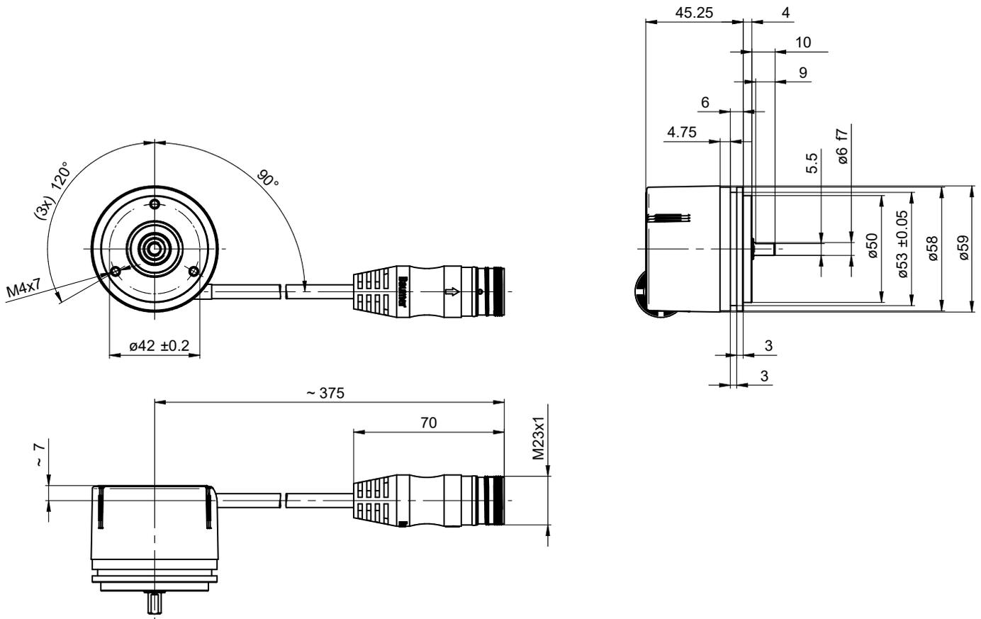
Servoflansch, Kabelstecker M23
