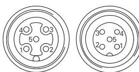
Für Verlängerungskabel ab 10 m paarweise (z.B. CAN\_H / CAN\_L) verdrehte Leitungen verwenden.
