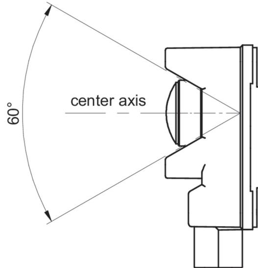
Objekte innerhalb eines Rotationskegels von  $\pm 30^\circ$  können je nach Position und/oder Oberflächenbeschaffenheit vom Sensor erfasst werden. Bei der Montage hinter einer Abdeckung müssen Materialeigenschaften und Dicke berücksichtigt werden, um eine übermäßige Dämpfung des Signals zu vermeiden. Metallhaltige Beschichtungen sind zu vermeiden. Die Auswirkung von Objekten im definierten Freibereich muss in der Anwendung überprüft werden. Lose Objekte sollten vermieden werden.
