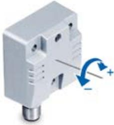
Der 1-dimensionale Neigungssensor muss so angebracht werden, dass die im Bild angezeigte Drehachse senkrecht zur Erdanziehung ausgerichtet ist. Die maximale Abweichung darf nicht mehr als  $\pm 3^\circ$  betragen.
