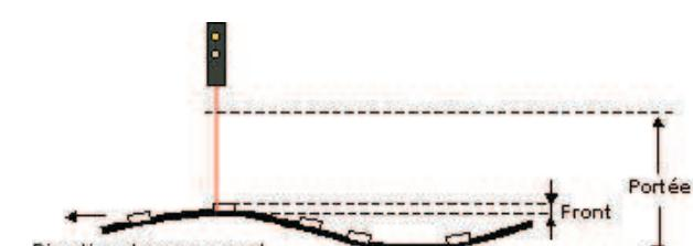
La différence de référence doit être apprise en début de procédure. Le capteur ne mémorisant que la différence, la distance de l'objet n'a pas d'incidence pour l'apprentissage. La plus petite différence qu'il est possible d'apprendre dépend de la distance de mesure (voir le diagramme)
