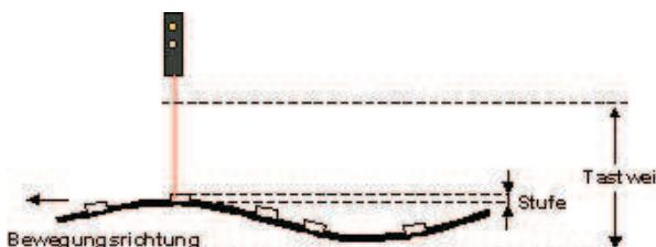
Die zu erkennende Stufe muss dem Sensor zuerst eingelernt werden. Da der Sensor nur die Differenz abspeichert, spielt im Allgemeinen die Distanz zur Stufe beim Einlernen keine Rolle. Wird jedoch die minimale Stufe gewünscht, so ist dies nur im Nahbereich möglich (siehe Diagramm).
