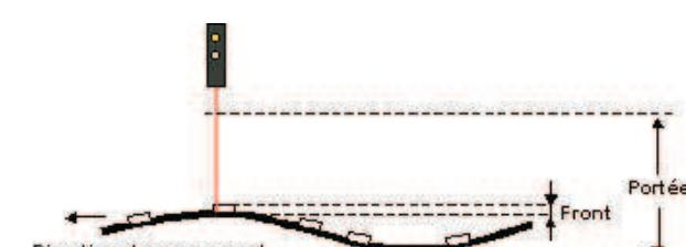
La différence de référence doit être apprise en début de procédure. Le capteur ne mémorisant que la différence, la distance de l'objet n'a pas d'incidence pour l'apprentissage. La plus petite différence qu'il est possible d'apprendre dépend de la distance de mesure (voir le diagramme)
