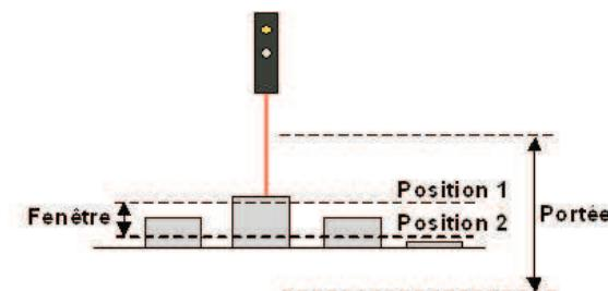
La différence de référence doit être apprise en début de procédure. Le capteur ne mémorisant que la différence, la distance de l'objet n'a pas d'incidence pour l'apprentissage. La plus petite différence qu'il est possible d'apprendre dépend de la distance de mesure (voir le diagramme)
