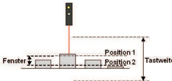
Die beiden Schwellwerte des Fensters müssen dem Sensor zuerst eingelernt werden. Wird das minimale Fenster gewünscht, so ist dies nur im Nahbereich möglich (siehe Diagramm).
