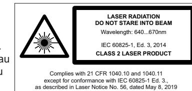
Aus Lasersicherheitsgründen muss die Spannungsversorgung dieses Sensors abgeschaltet werden, wenn die ganze Anlage oder Maschine abgeschaltet wird.
