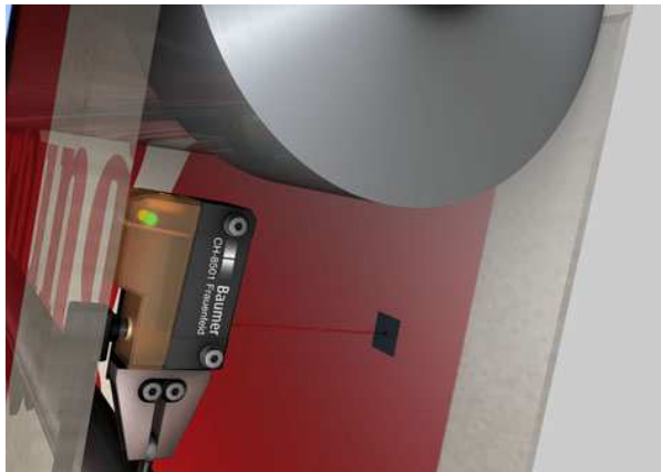
Bild 4b: Ein Reflexions-Lichttaster mit Intensitätsunterscheidung detektiert Druckmarken auf Rollbandwerbung (Detailansicht)
