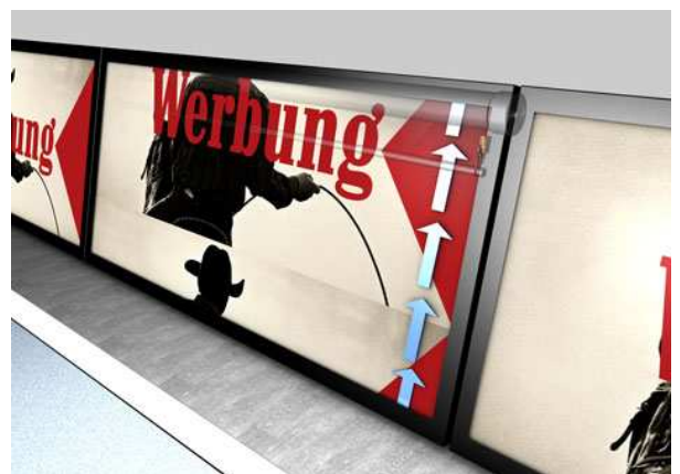
Bild 4a: Ein Reflexions-Lichttaster mit Intensitätsunterscheidung detektiert Druckmarken auf Rollbandwerbung
