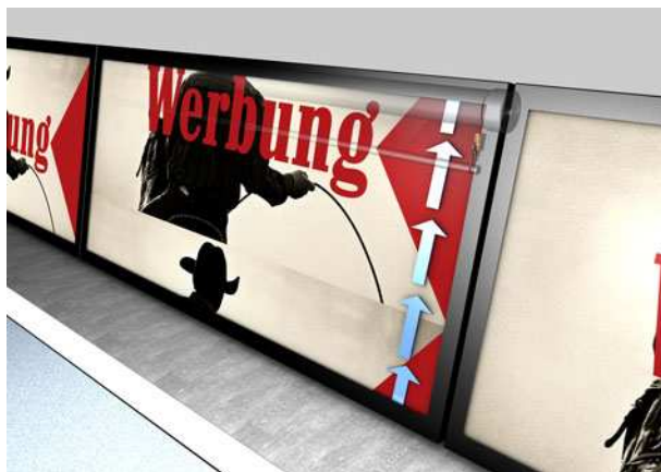
Illustration 4a: Un détecteur réflex énergétique détecte des repères d'impression sur des bandes publicitaires défilantes
