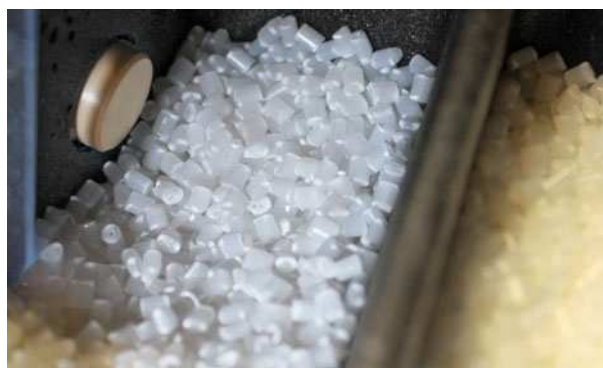
Illustration 5 : Même si la température est élevée comme sur cette machine pour le traitement de colles chaudes, les détecteurs capacitifs conviennent parfaitement bien pour la mesure des niveaux.
