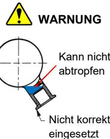
Wenn die Dichtung undicht ist und die Medien in der Kontrollbohrung sichtbar werden, muss die Dichtung sofort ausgetauscht werden.
