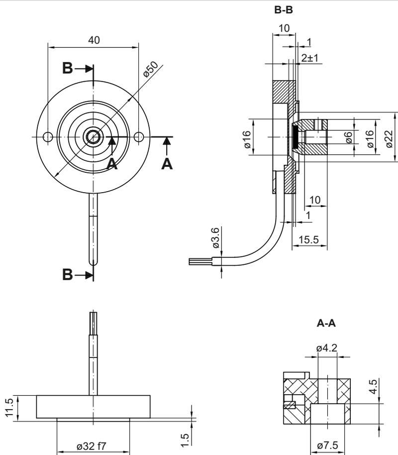
Avec câble, rotor magnétique avec perçage  $\varnothing 6$  mm (cylindre)
