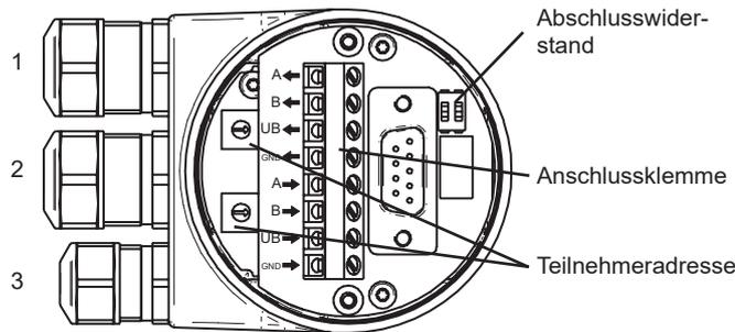
Kabel: 1, 2 = ø8-10 mm (-40-85 °C) / ø5-9 mm (-25-85 °C)
