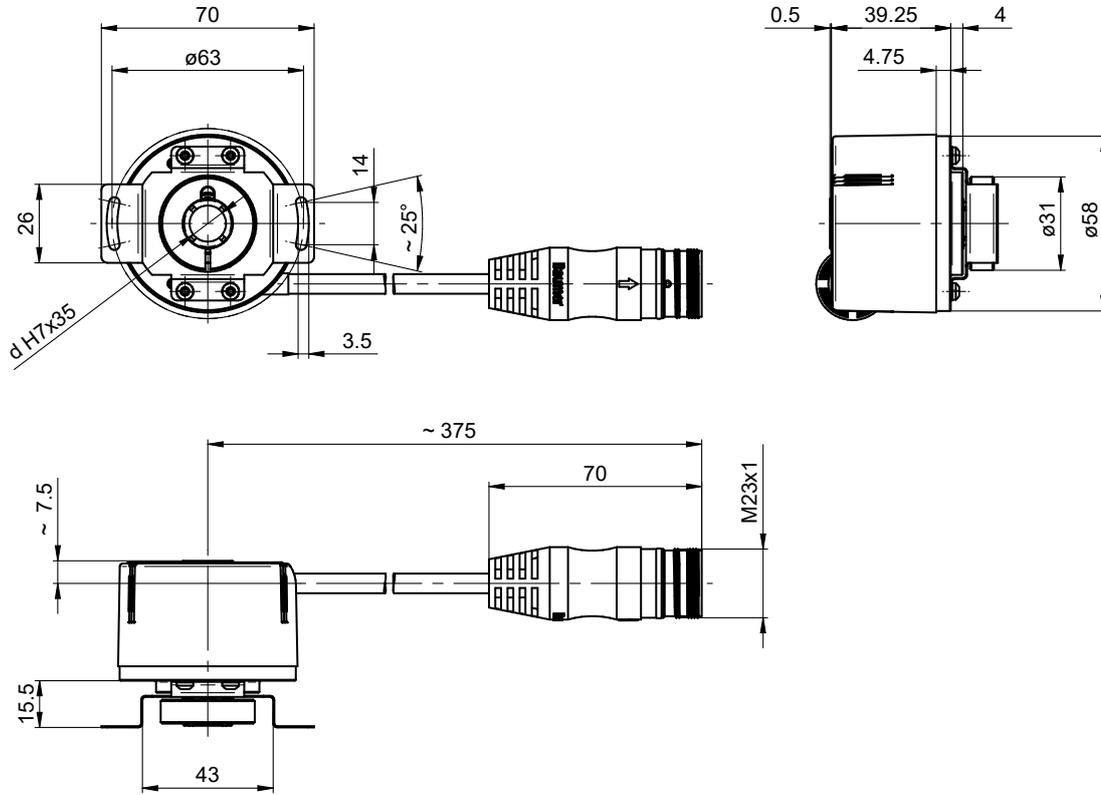
Axe creux traversant, raccordement sortie câble avec connecteur M23
