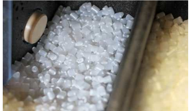
Bild 5: Auch wenn es heiss hergeht wie bei dieser Maschine zur Heissleimverarbeitung, eignen sich kapazitive Sensoren für die Füllstandsmessung.
