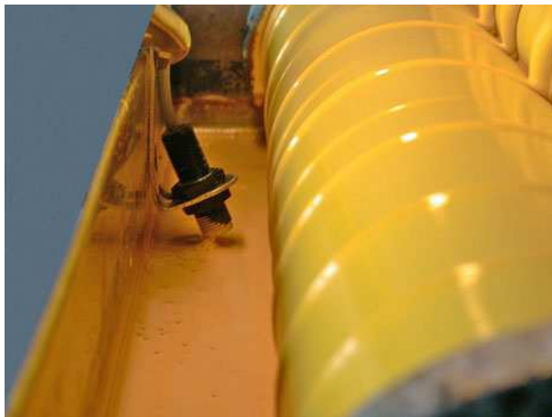
Bild 4: Auch die Füllstände in grossen Farbtanks lassen sich mit kapazitiven Sensoren überwachen.
