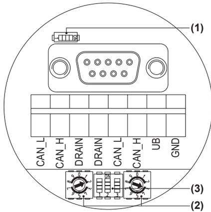
Les bornes de même fonction sont reliées entre elles dans le boîtier bus. Courant max. 1 A pour les bornes d'alimentation codeur UB et GND.
