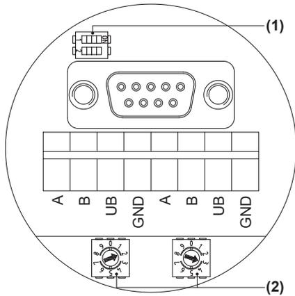
Anschlüsse mit gleicher Bezeichnung sind intern verbunden und funktionsidentisch. Diese internen Klemmverbindungen UB-UB / GND-GND dürfen mit max. je 1 A belastet werden.
