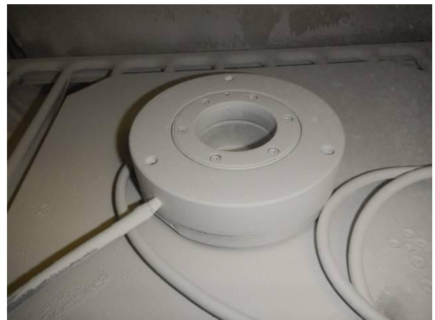
Bild 4 Drehgeber HOGS151 DN 5000 und Nr. 5.2 - in der Staubkammer SK 160 nach der Staubschutzprüfung IP6X
