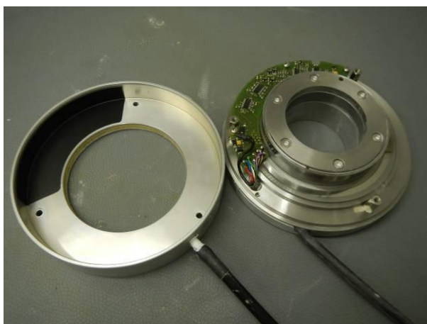
Bild 5 Drehgeber HOGS151 DN 5000 ohne erkennbare Staubschichten im Inneren nach der Staubschutzprüfung IP6X
