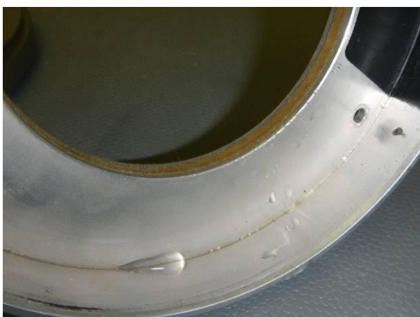
Bild 11 Drehgeber HOGS151 DN 5000 mit erkennbaren Wasserspuren im Inneren nach der Spritzwasserschutzprüfung IPX4
