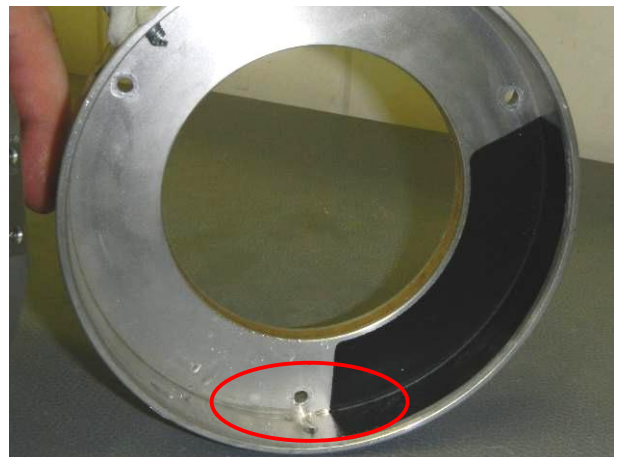
Bild 10 Drehgeber HOGS151 DN 5000 mit erkennbaren Wasserspuren im Inneren nach der Spritzwasserschutzprüfung IPX4
