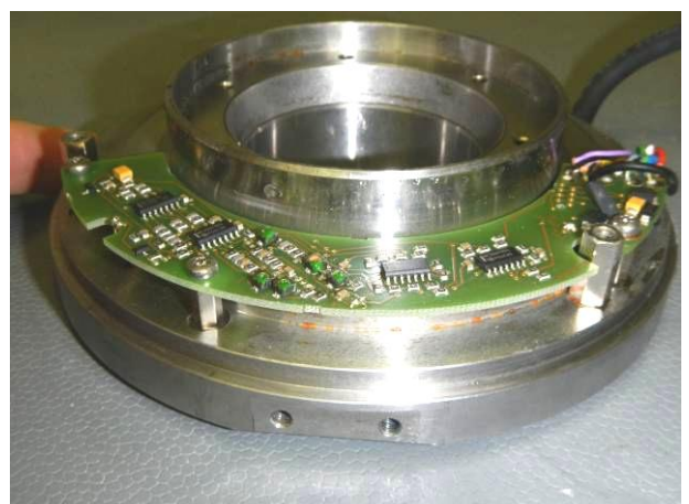
Bild 12 Drehgeber HOGS151 DN 5000 ohne erkennbare Staubs Spuren auf der Platine nach der Spritzwasserschutzprüfung IPX4
