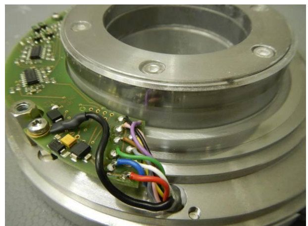
Bild 6 Drehgeber HOGS151 DN 5000 ohne erkennbare Staubschichten im Inneren nach der Staubschutzprüfung IP6X
