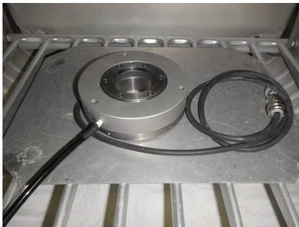
Bild 3 Drehgeber HOGS151 DN 5000 in der Staubkammer SK 160 vor der Staubschutzprüfung IP6X
