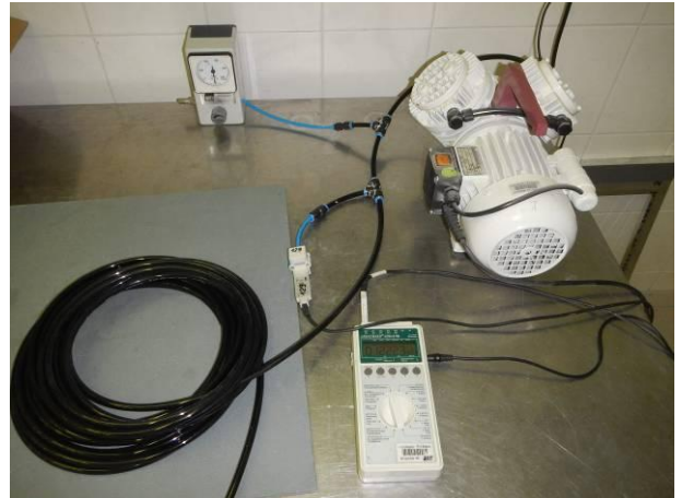
Bild 8 Drehgeber HOGS151 DN 5000 mit Equipment zur Überdruckeinstellung vor der Spritzwasserschutzprüfung IPX4
