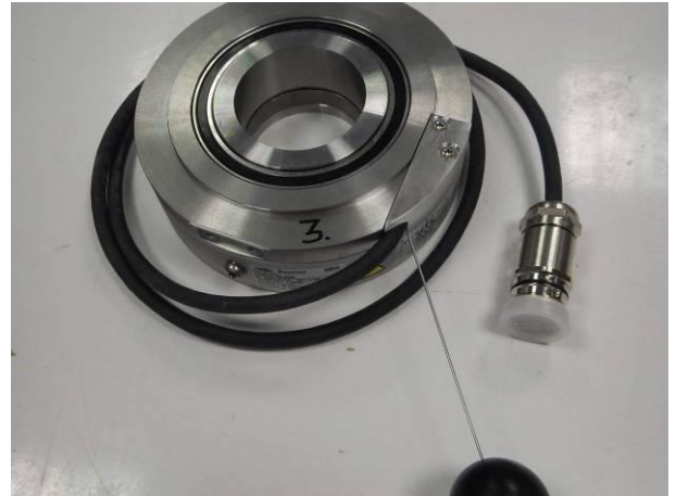
Bild 2 Drehgeber HOGS151 DN 5000 mit genormten Prüfdraht (Ø 1 mm, 1 N) während der Berührungsschutzprüfung IP6X
