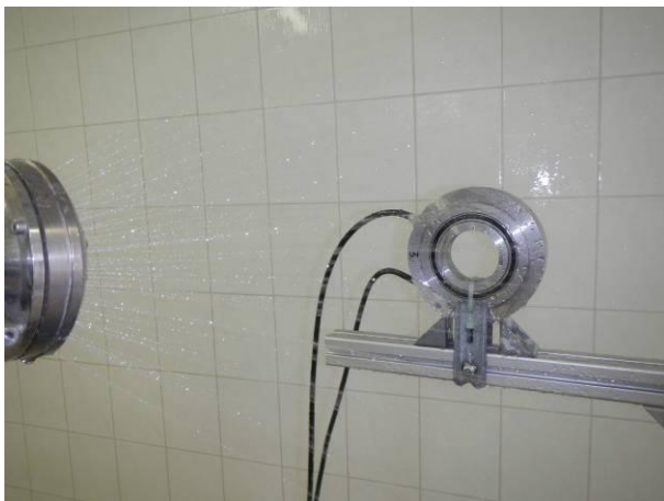
Bild 9 Drehgeber HOGS151 DN 5000 mit genormter Spritzwasserbrause während der Spritzwasserschutzprüfung IPX4
