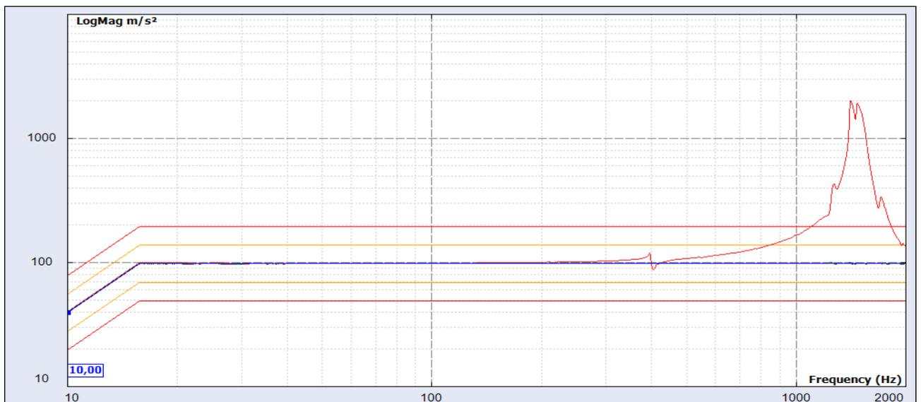
Schwingen, sinusförmig, Y-Achse, - Regelkanal, - Beschleunigung am Prüfling (Messkanal 3)
