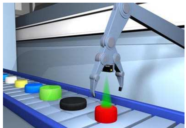
Bild 6: An einem Greifer wird ein Ultraschall-Sensor zur farzunabhängigen Distanzmessung verwendet.
