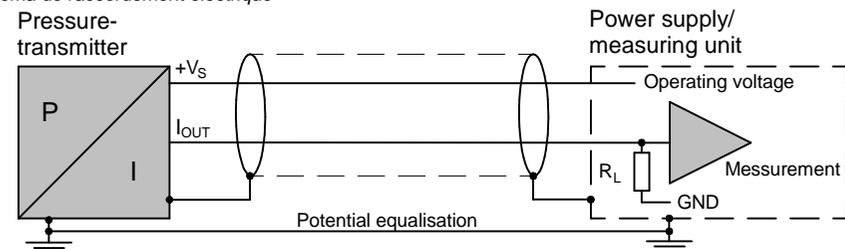
Betriebsspannung / supply voltage / tension d'alimentation.....V<sub>S</sub>: 8...30 VDC
