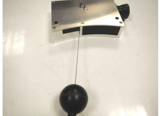
Bild 2 Sensorkopf MHAP XXX Prüfling mit genormten Prüfdraht (Ø 1 mm, 1 N) bei der Berührungsschutzprüfung IP6X
