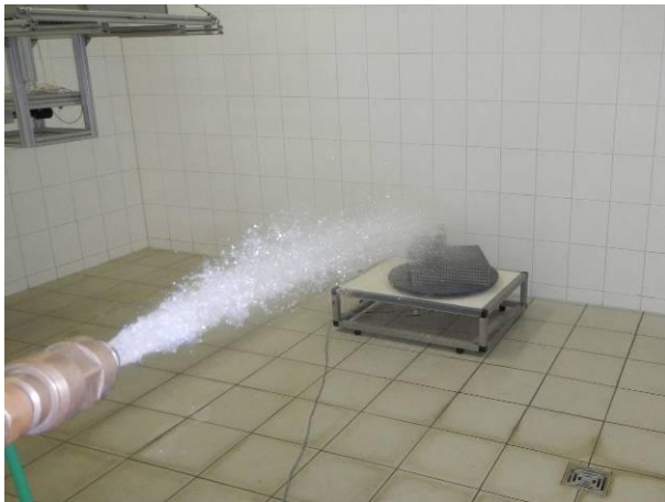
Bild 9 Sensorkopf MHAP XXX auf dem Drehtisch mit Wasserstrahl aus Strahldüse während der Strahlwasserprüfung IPX6
