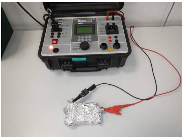
Bild 5 Sensorkopf MHAP XXX Prüfling mit Portable Compact Tester Isolationsprüfung nach der Tauchersatzprüfung IP6X
