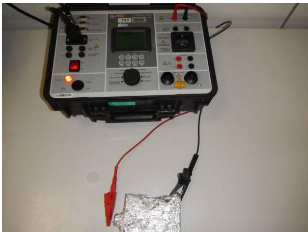
Bild 11 Sensorkopf MHAP XXX ohne Prüfling mit Portable Compact Tester Isolationsprüfung nach der Strahlwasserprüfung IPX6
