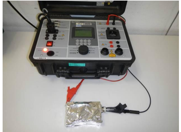
Bild 8 Sensorkopf MHAP XXX Prüfling mit Portable Compact Tester Isolationsprüfung nach der Tauchwasserprüfung IPX7
