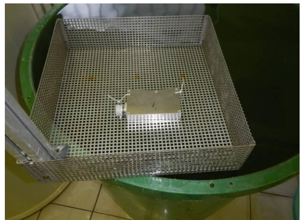
Bild 6 Sensorkopf MHAP XXX Prüfling am Tauchkorb befestigt vor der Tauchwasserprüfung IPX7
