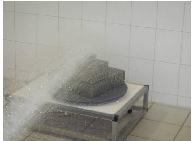
Bild 10 Sensorkopf MHAP XXX auf dem Drehtisch mit Wasserstrahl aus Strahldüse während der Strahlwasserprüfung IPX6
