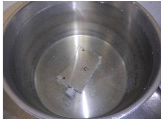
Bild 4 Sensorkopf MHAP XXX Prüfling im Tauchbecken 200 mm während der Tauchersatzprüfung IP6X
