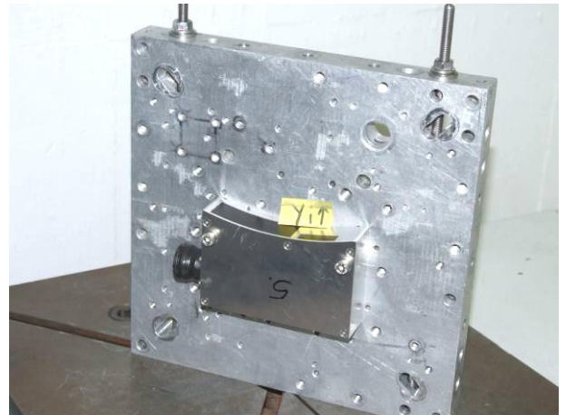
Bild 10 Sensorkopf MHAP auf dem auf dem Stoßtisch mit Beschleunigungssensor beim Schocken in der Y-Achse, negative Richtung
