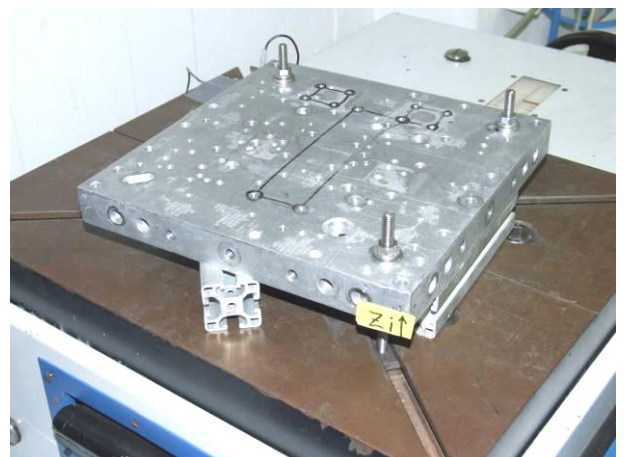
Bild 12 Sensorkopf MHAP auf dem auf dem Stoßtisch mit Beschleunigungssensor beim Schocken in der Z-Achse, negative Richtung
