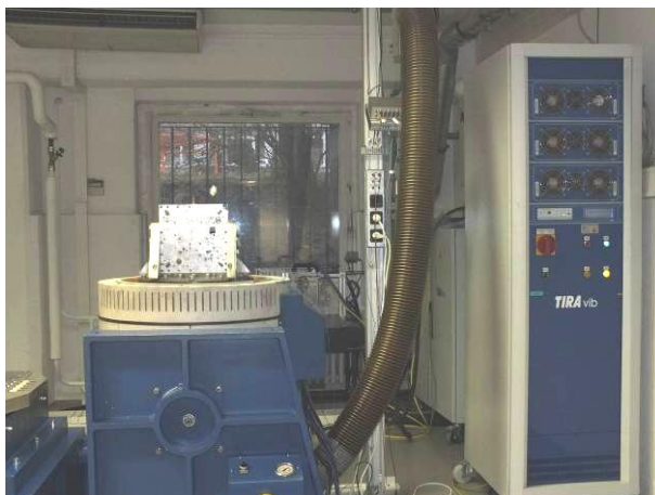
Bild 3 Sensorkopf MHP auf der Schwingprüfanlage beim Schwingen in der Y-Achse
