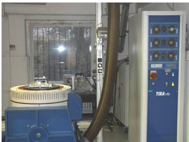
Bild 5 Sensorkopf MHP auf der Schwingprüfanlage beim Schwingen in der Z-Achse
