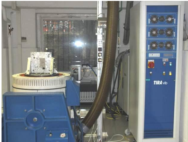
Bild 1 Sensorkopf MHP auf der Schwingprüfanlage beim Schwingen in der X-Achse
