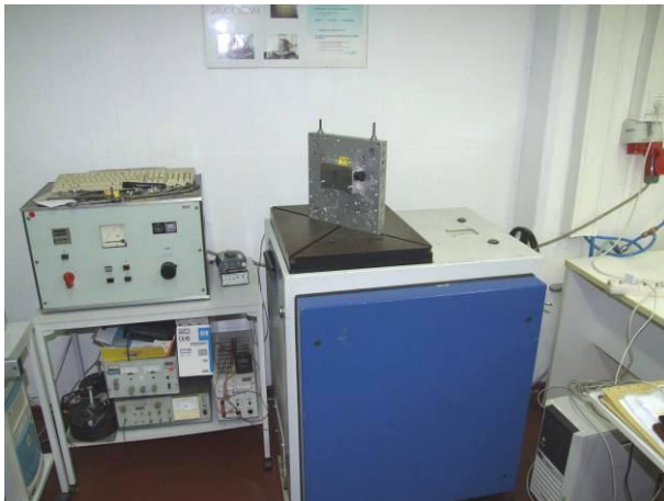
Bild 9 Sensorkopf MHAP auf dem Stoßtisch mit Beschleunigungssensor beim Schocken in der Y-Achse, positive Richtung
