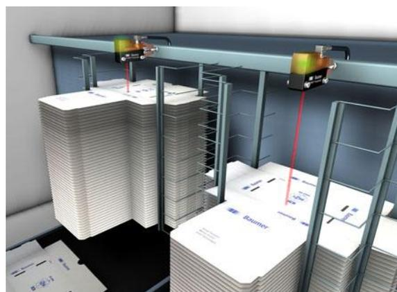
*Illustration 2: Mesure de la hauteur des piles dans l'industrie de l'impression ou de l'emballage avec des détecteurs de mesure opto-électroniques*
