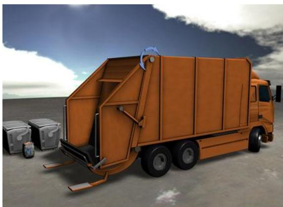
*Illustration 6: Contrôle de l'angle d'inclinaison du dispositif de chargement pour bennes à ordures avec des détecteurs angulaires magnétiques*
