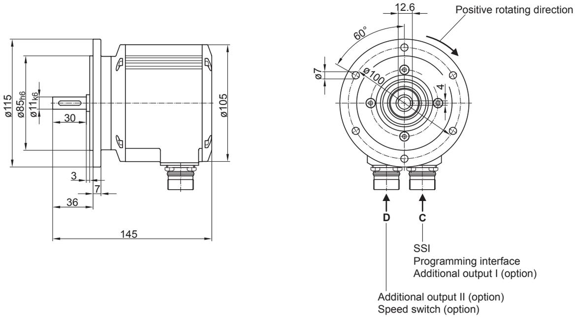
带M23径向法兰接头和欧式法兰B10
