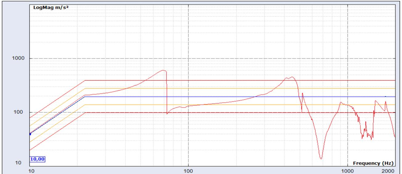
Schwingen, sinusförmig, X-Achse, - Regelkanal, - Beschleunigung am Prüfling (Messkanal 3)
