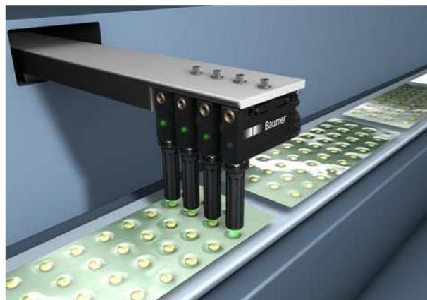
*Illustration 5: Les détecteurs à ultrasons contrôlent la présence de comprimés dans des emballages transparents*
