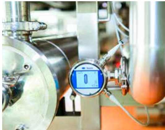
Bei Optimierungen des CIP-Reinigungsprozesses können dank des Baumer Leitfähigkeitssensors CombiLyz AFI bis zu 100 000 Liter Wasser pro Tag eingespart werden.
