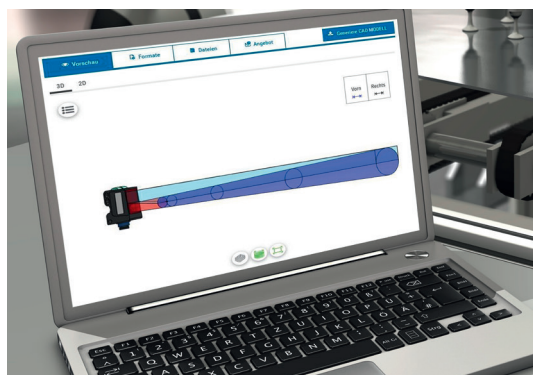
Bild 4: Der Strahlverlauf ist in die 3D CAD Daten integriert. Das erleichtert den Weg vom Design-In bis zur Montage, denn der Sensor lässt sich ohne Feinjustage exakt so einbauen wie konstruiert.
