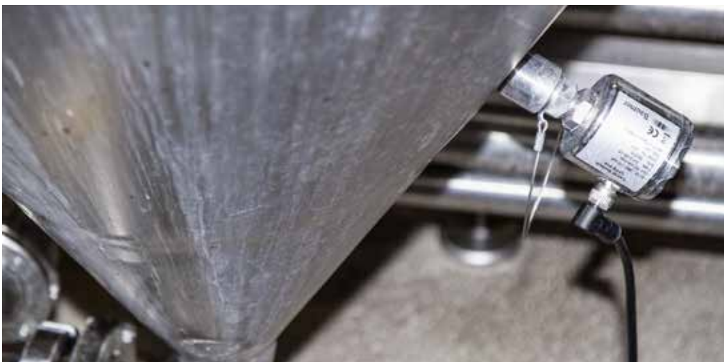
Un détecteur de niveau CleverLevel installé sur un bac tampon.
