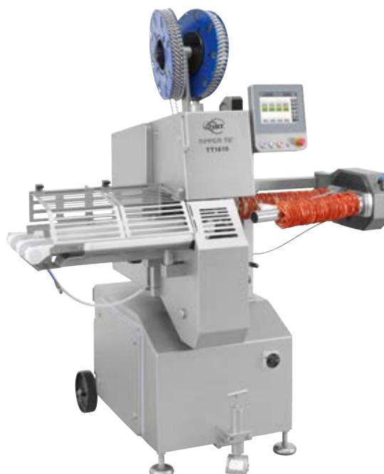
Die modernen TT Doppelclip-Automaten im Hygienedesign verschliessen die Wurstportionen effizient und präzise ohne Brätückstände in den Wurstzipfeln. Sie werden auch für die Verpackung von Konditoreihalfabrikaten, Käse, Suppen und Non-Food-Produkte eingesetzt.
